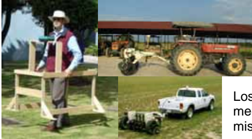
Fig B1. Imágenes de aparatos usados para medir conductividad eléctrica en suelos agrícolas.
