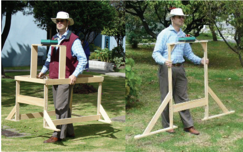
Fig A1. Dos aparatos que se usan en LOGEMIN S.A. para medir conductividad eléctrica en el terreno.
