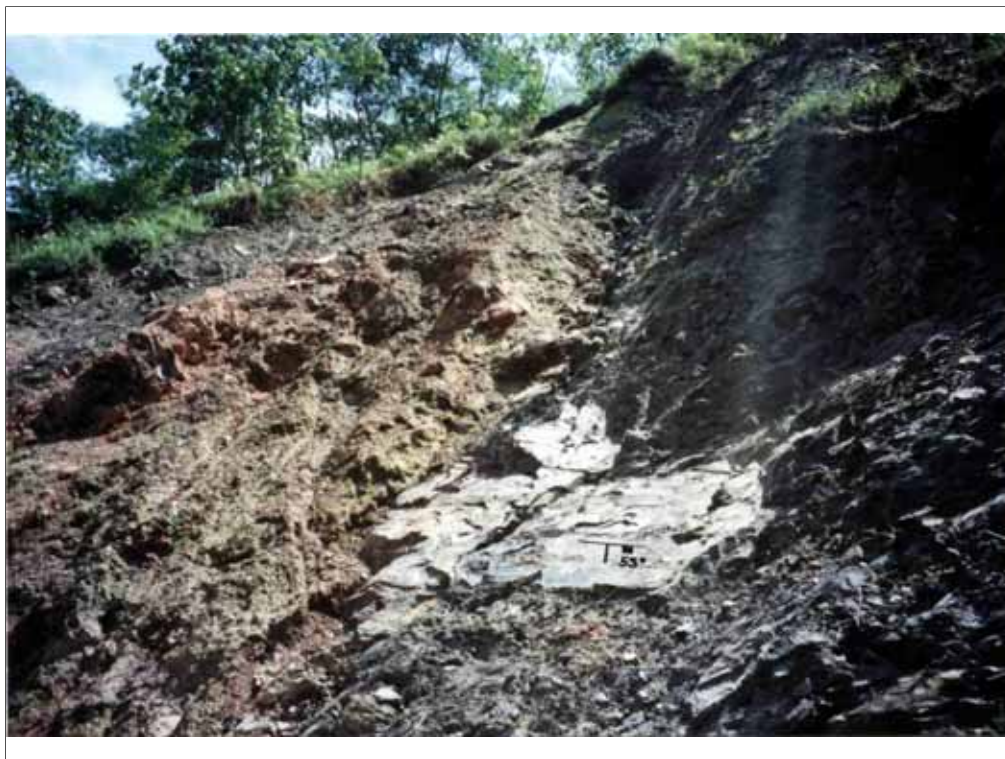
Foto 14. Masa deslizada (Qd) en el contacto con las lodolitas de la Formación Trincheras (Kitr). Estación G30. Plano de deslizamiento que sigue las diaclasas 220/55^\circ (K 5 + 700).
